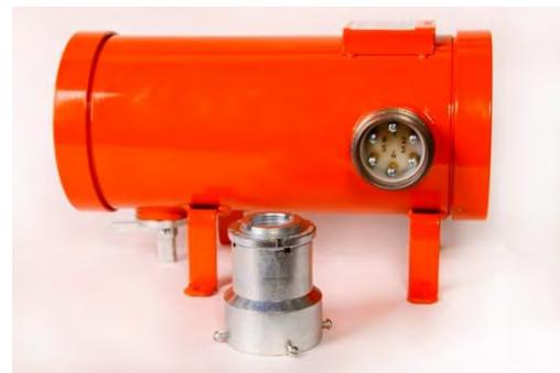
Данные взрывозащищенные приводы имеют взрывобезопасный вид взрывозащиты "взрывонепроницаемая оболочка" и маркировку взрывозащиты IExdIICT6 по ГОСТ Р 51330.0-99. Степень защиты оболочки электрооборудования от проникновения твёрдых предметов и воды в соответствии с международным стандартом - IP54 по ГОСТ 14254-96. Электроприводы во взрывозащищенной оболочке относятся к невосстанавливаемым, неремонтируемым.
